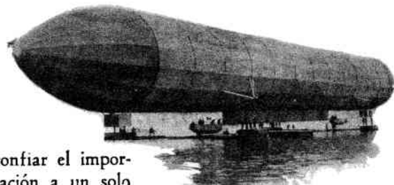
El LZ-2, la segunda aeronave del Conde Zeppelin, sobre su plataforma flotante, en 1906. El aparato tenía 420 pies de largo.
